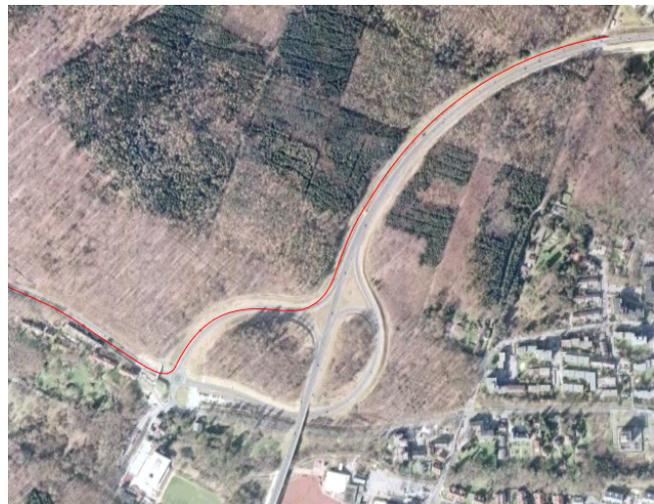
Bild 5. – Umsetzung der GPS-Fahrwegkoordinaten in das virtuelle Fahrwegprofil
